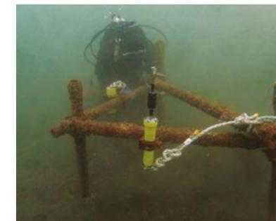
▲写真3 公社職員によるクロロフィル濁度計・電磁式流速計の設置状況
