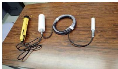
▲図1 システム一式、バッテリー、送信機、センサー
