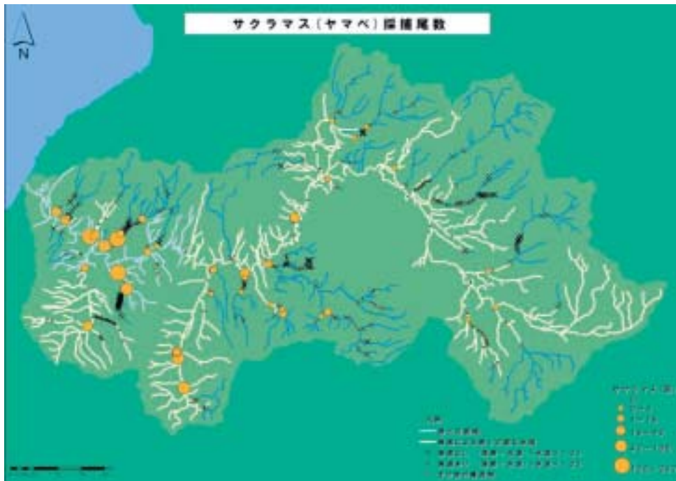
図2 GISにより推定された尻別川におけるサクラマス遡上可能範囲。水色の部分は魚道がなくても遡上できる範囲、白い部分は魚道の設置により現在遡上が可能となっている範囲、濃い青の部分は魚道のない堰堤により遡上ができないと考えられる範囲。×は魚道のない河川横断構造物の位置、オレンジ色の●はサクラマス幼魚（ヤマベ）の生息数を示す。魚道設置によりサクラマスの遡上可能範囲は確実に回復しているものと推定された。
