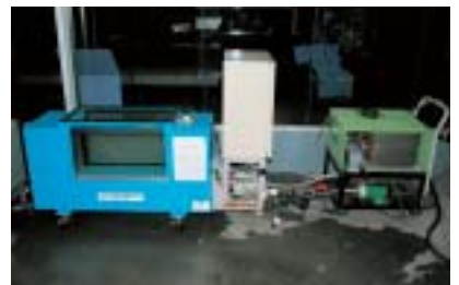
図3 循環式水槽．左は水槽と流速制御装置、右は水温制御装置．
