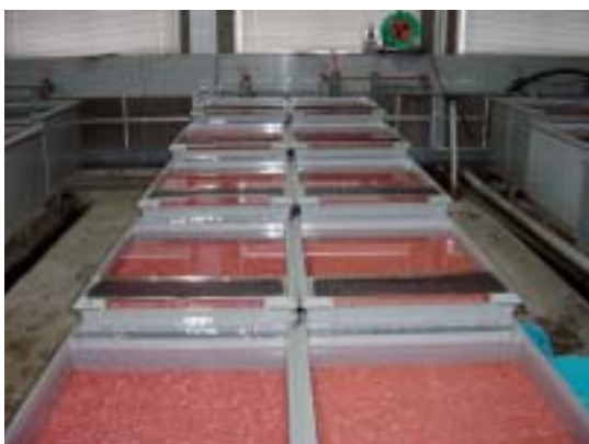
写真4 ボックス型孵化器 写真奥から手前へと水が向かう。注水は一旦ボックスの下方に流れ、湧昇流となって卵の間を上り次の段へとオーバーフローする。
