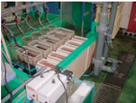
写真3 銅イオンによるミズカビ防除試験風景
