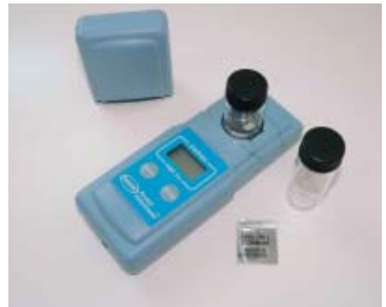
写真2 銅イオン測定用ポケット比色計
