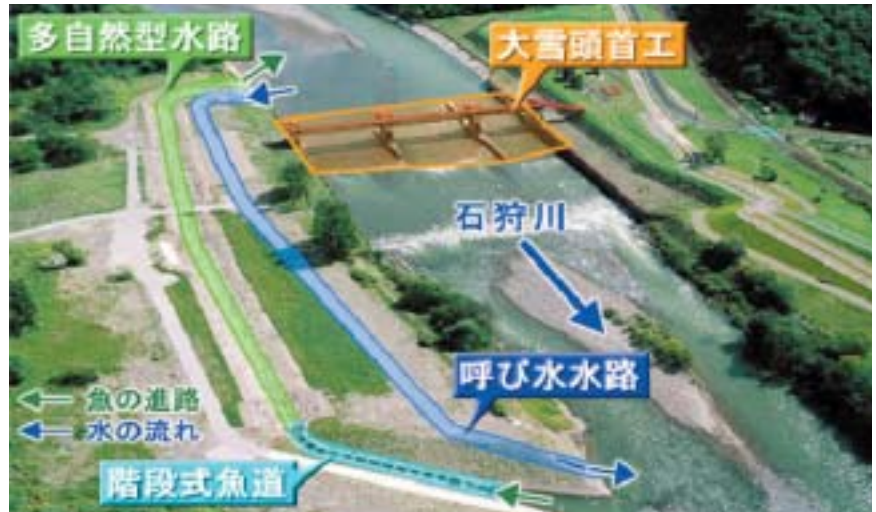
写真4 大雪頭首工における魚道整備全景 (旭川開発建設部ホームページ http://www.as.hkd.mlit.go.jp より引用)
