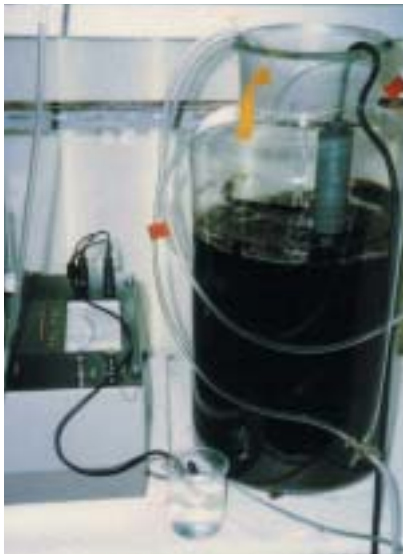
図7 アラメ配偶体の大量培養装置
