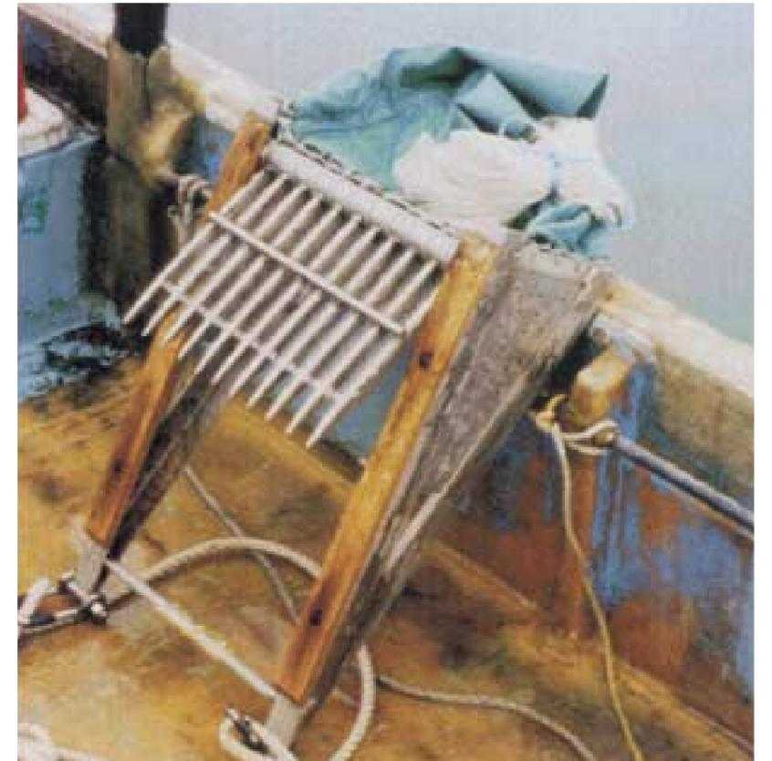
写真1 調査に用いた桁曳網
