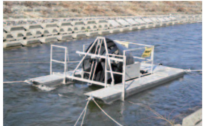
写真-4(2) ドラムが水中から出ているスクリュートラップ
