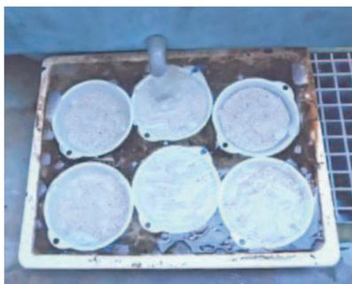
図10 ゼオライトを実験用ナマコのストック水槽の排水に曝し、微生物を培養しているところ。2週間以上放置し、清浄海水で洗ってから飼育実験に用いた
