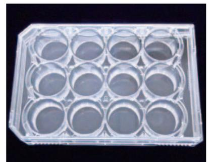
図2 幅広い解析に用いるマルチウェルプレートの例
